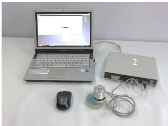
Обозначения: 1– пользовательский интерфейс программы; 2– электронный согласующий блок, включающий USB модуль ввода-вывода сигналов; 3 – вибродатчик механических параметров тканей.
